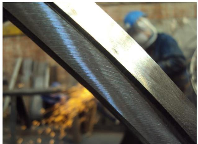
*Inspección y Control de Calidad a Biseles, según Especificación Procedimiento de Soldadura.*
