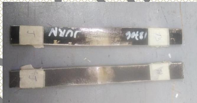
PROBETA DE SOLDADURA CAÑERIA
