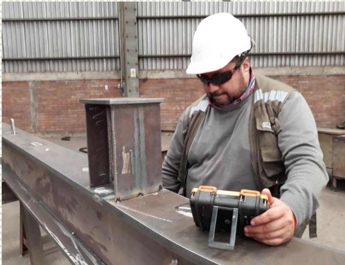
**APLICACIÓN TECNICA ULTRASONIDO, BARRIDO CON HAZ ANGULAR A CORDON DE SOLDADURA.**
