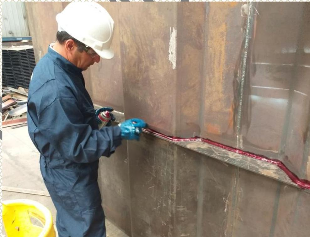
**APLICACIÓN TECNICA LIQUIDOS PENETRANTES A CORDON DE SOLDADURA**
