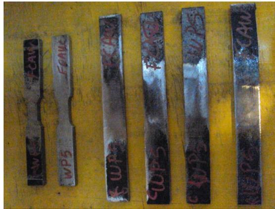
*Probetas a ensayar en tracción y Doblado Guiado, según Código de Soldaduras a utilizar en la fabricación.*
